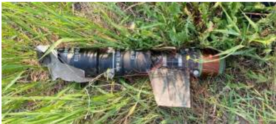
Секція двигуна відстріляної ракети 9M116. Зображення © Державна служба України з надзвичайних ситуацій
