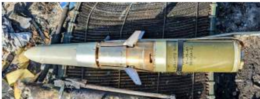
Бойова частина ракети AT-16 і відсік наведення. Зображення © Шон Мурхаус (Sean Moorhouse)
